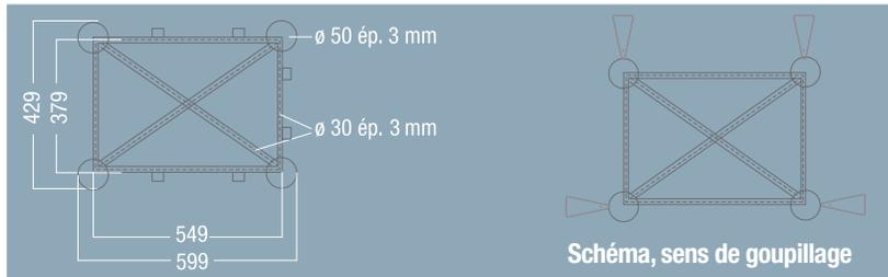
Structure aluminium pré-rig section 599 x 429 m. Réalisé en tube  $\varnothing 50$  x 3 6005T6 et  $\varnothing 30$  x 3 6106T6.
